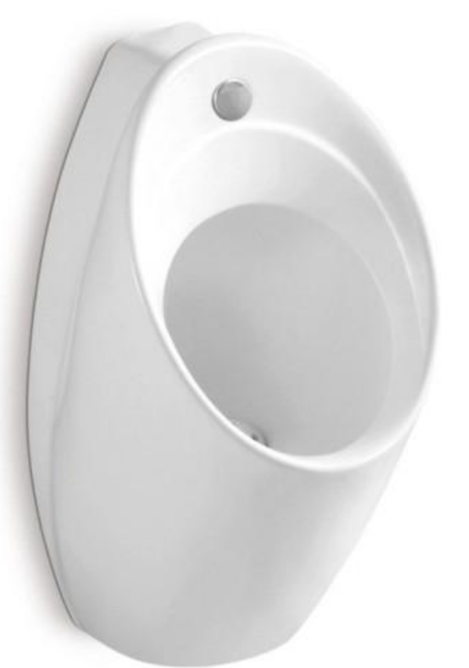
HS-Q730 Wall-hung urinal Size:340*320*630mm 排水方式:横排、直排 进水到墙排中心距离310mm
