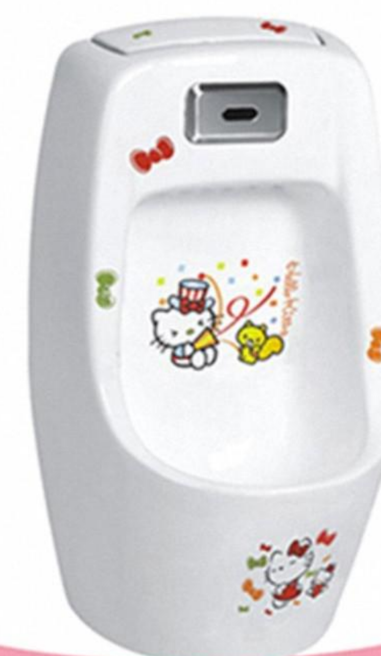
HS-006K(儿童挂式小便斗) Wall-hung urinal 285*240*500mm 排污口中心离墙: 80mm 排污口中心离地: 80mm
