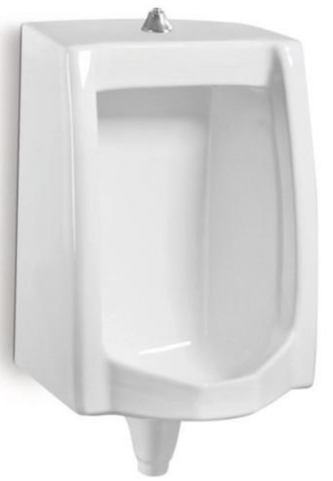
HS-Q725 Wall-hung urinal Size:330*350*690mm 排水方式:横排、直排 进水到墙排中心距离490mm
