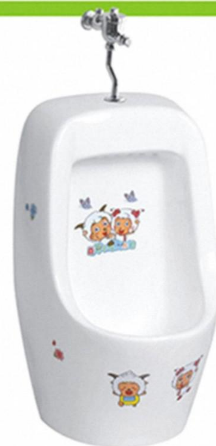
HS-003X(儿童挂式小便斗) Wall-hung urinal 285*240*490mm 排污口中心离墙: 70mm 排污口中心离地: 80mm
