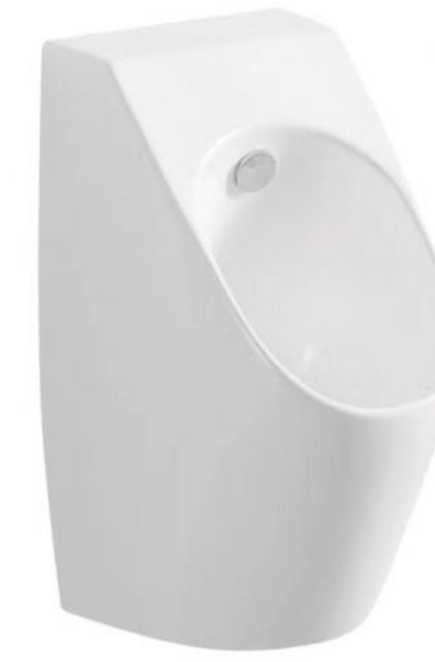
HS-Q340 Wall-hung urinal Size:330*360*605mm 排水方式:横排 顶进水到墙排中心距离480mm 背进水到墙排中心距离370mm
