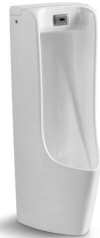
HS-Q702 Standing urinal Size:395*390*1020mm 排水方式:直排 排污口中心距离220mm
