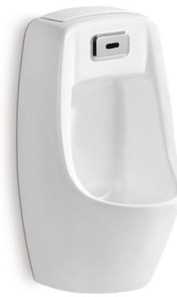
HS-Q733 Wall-hung urinal Size:250*300*500mm 排水方式:横排、直排 进水到墙排中心距离420mm
