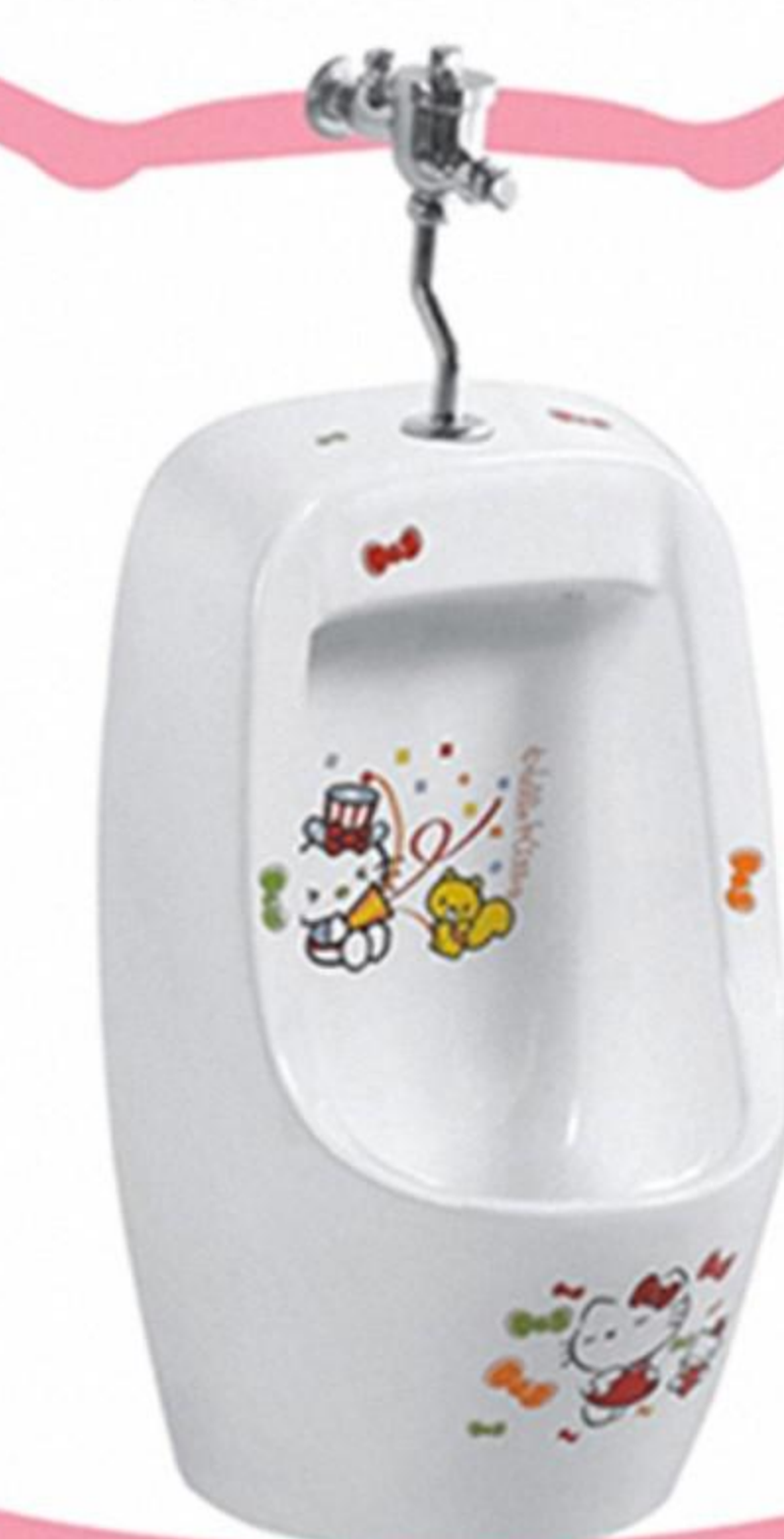
HS-003K(儿童挂式小便斗) Wall-hung urinal 285*240*490mm 排污口中心离墙: 70mm 排污口中心离地: 80mm
