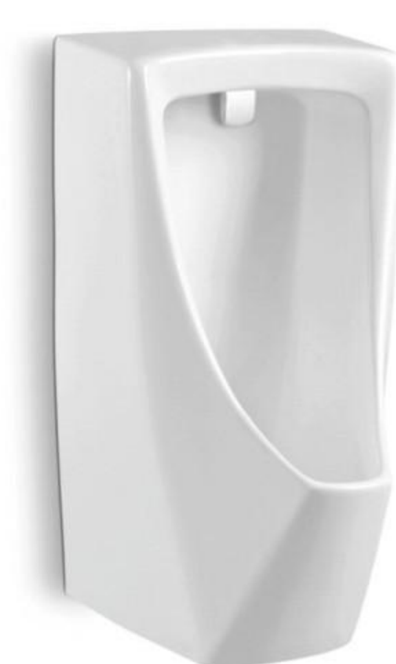
HS-Q738 Wall-hung urinal Size:330*320*600mm 排水方式:横排、直排 顶进水到墙排中心距离540mm 背进水到墙排中心距离440mm
