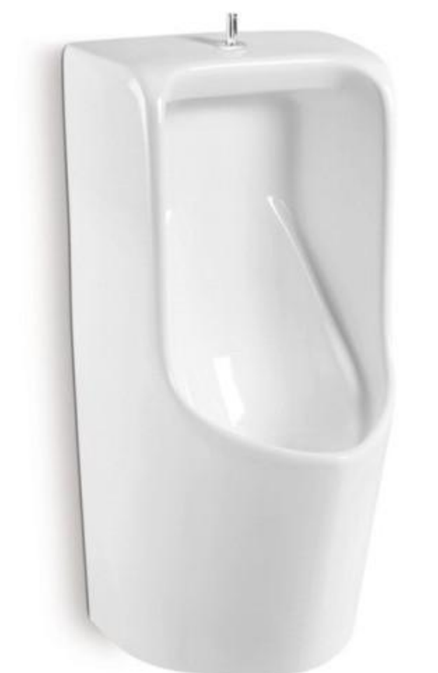
HS-Q737 Wall-hung urinal Size:340*400*760mm 排水方式:横排、直排 进水到墙排中心距离660mm
